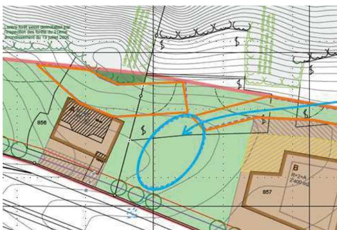
Figure 23 : Indication des emprises des digues de protection (en orange), du sens de l'écoulement des eaux (flèche) et du bassin de rétention (en bleu)
